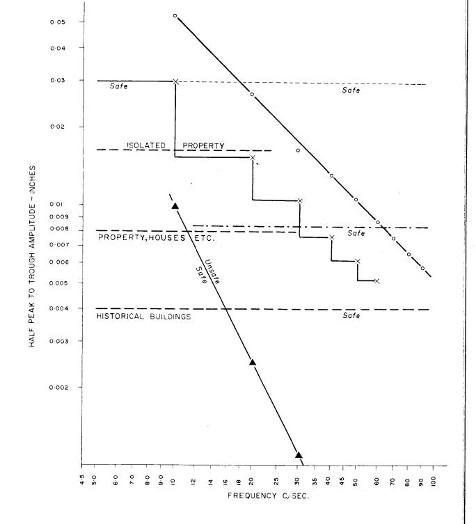
MAXIMUM SAFE HALF PEAK TO TROUGH AMPLITUDE OF VIBRATION
