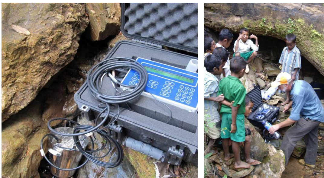
Figure 4: Teste hodi sukat rai-kuak uza metru multi barometru
